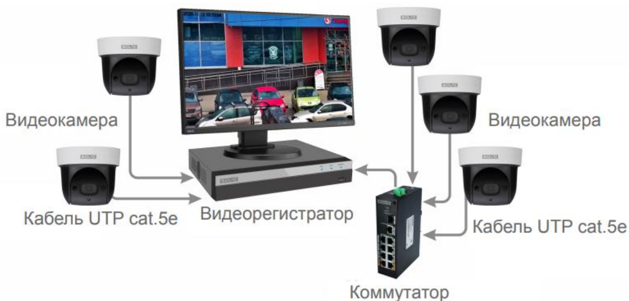
Рисунок 6.4 – Схема подключения видеокамеры к видеорегистратору
