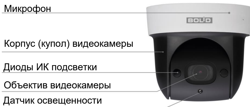
Рисунок 4.1 – Внешний вид и основные элементы видеокамеры
