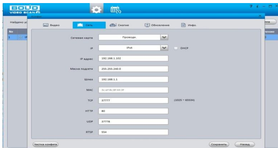
Рисунок 12.2 – Изменение IP-адреса видеочамеры с помощью утилиты «BOLID VideoScan»
