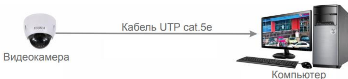
Рисунок 6.2 – Схема подключения видеокамеры к компьютеру
