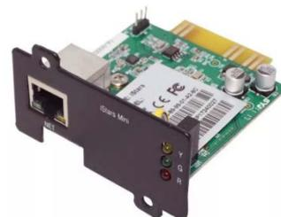
2.4.9.2 Карта сухих контактов AS400 предназначена для преобразования внутренних сигналов ИБП в сигналы интерфейса «Сухие контакты» с гальванической развязкой. Карта обеспечивает передачу от ИБП аварийных сигналов, а также информацию о режиме работы ИБП.
