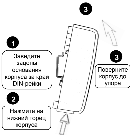
Рисунок 3. Крепление контроллера на DIN-рейку
