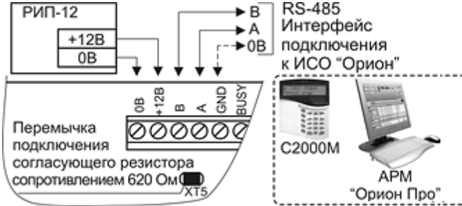
Рисунок 4. Схема подключения по интерфейсу RS-485
