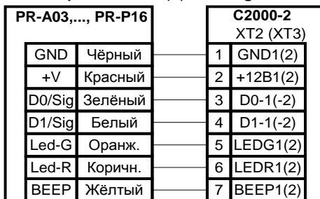
Рисунок 14. Схема подключения считывателей Proxy-2A исп.01, Proxy-2M, Proxy-2MA, Proxy-3A, Proxy-3M, Proxy-3MA
