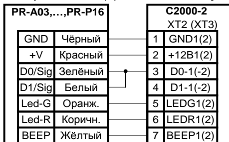
Рисунок 14. Схема подключения считывателей Proxy-2A исп.01, Proxy-2M, Proxy-2MA, Proxy-3A, Proxy-3M, Proxy-3MA
