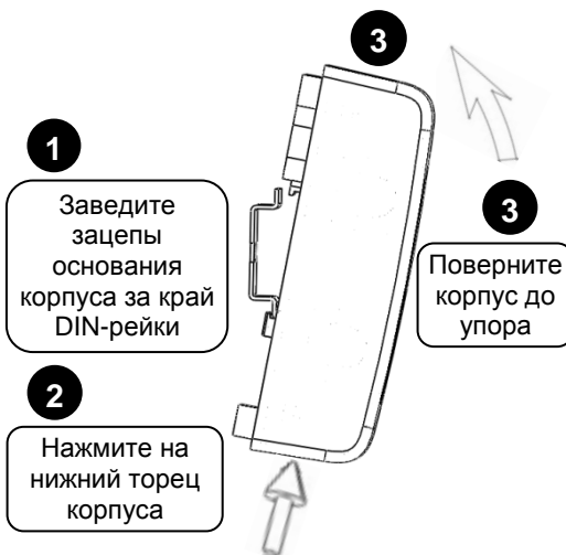
Рисунок 3. Крепление блока на DIN-рейку
