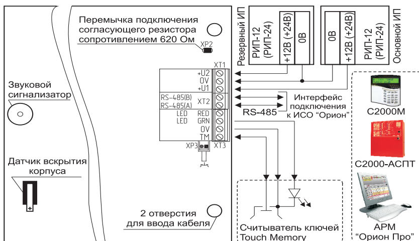
Рисунок 3. Схема внешних соединений блока «С2000-ПТ»
