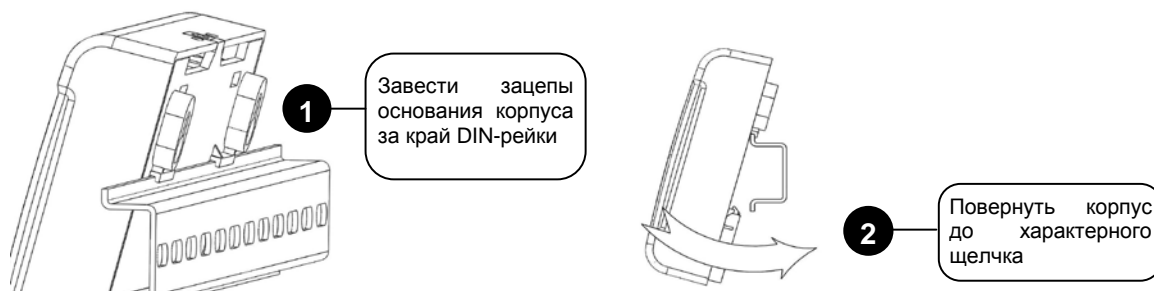
Рисунок 4. Монтаж прибора на DIN-рейку
